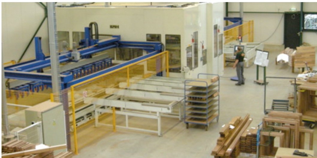
In alto, ISA BHM ES 22, la nuova cella di lavorazione dei serramenti in legno installata in una fabbrica olandese; a destra, alcune immagini delle teste di foratura/fresatura per i metalli; sotto, i fratelli Renzo e Luciano Tagliaferri
